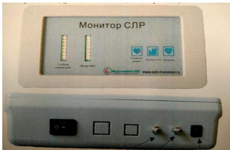
Кнопка «вкл./выкл» ИВЛ компрессия гнездо светого адаптера
