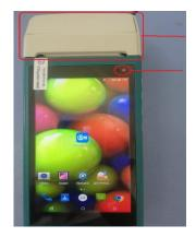
Терминал представляет из себя планшетный ПК работающий подоперационной системе Android, и встроенным термопринтером, расположенном в верхней части корпуса устройства. Для зарядки терминала в комплект входит подставка с адаптером. Включите адаптер в сети и установите на нее терминал. О начало процесса зарядка будет сигнализировать светодиод, расположенный в правой верхней части экрана.
