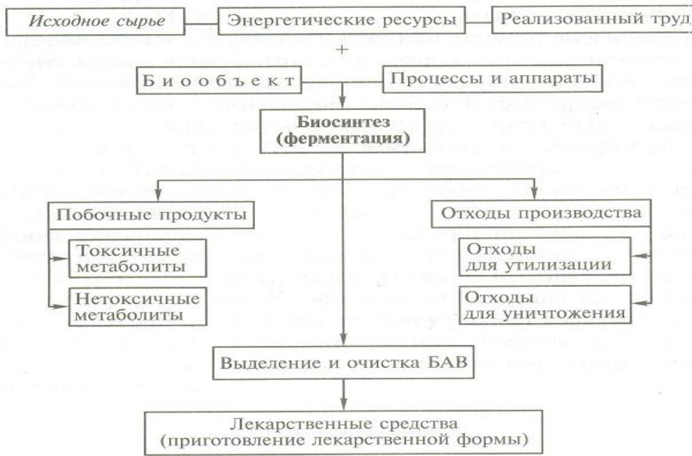
Рис. 9. Общая схема биотехнологического производства
