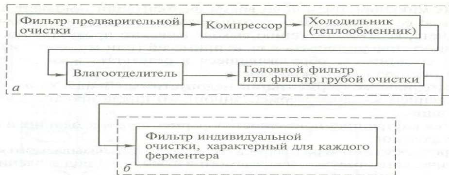
Рис. 11. Схема очистки технологического воздуха (стрелками показано направление потока воздуха):
