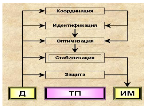
Сурет 1.1. ТҮ АБЖ функционалды құрылымы
