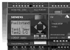
Сурет 15. 2 SIEMENS фирмасының миниатюрлы ПЛК-сы
