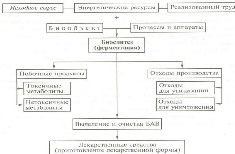
Рис. 9. Общая схема биотехнологического производства
