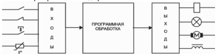
Рисунок 15.1 Принцип работы ПЛК
