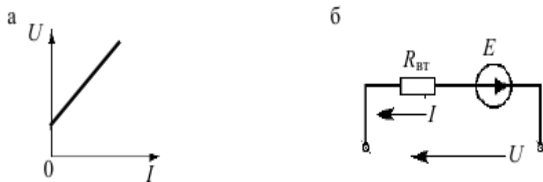
Рисунок 2.7 - Вольт-амперная характеристика (а) активного приемника
