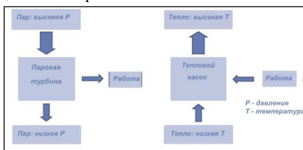
Рисунок 6.2 - Сравнение принципов работы цикла теплового двигателя и цикла теплового насоса
