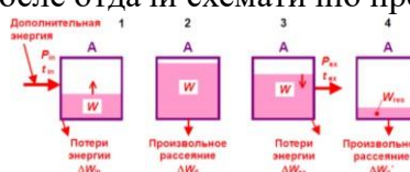
Рисунок 7.1 - Состояние аккумулятора энергии (А) (упрощенно).
