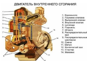
Рисунок 12.3 – Внутреннее устройство двигателя внутреннего сгорания
