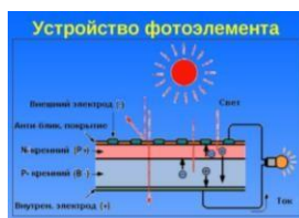
Рисунок 3.9 – Устройство солнечного элемента
