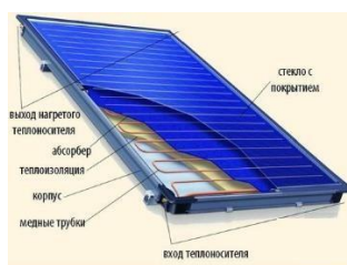
Рисунок 3.7 – Конструкция плоского солнечного коллектора
