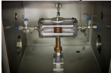
Рисунок 14.5 - Лабораторный прототип гибридной солнечной установки
