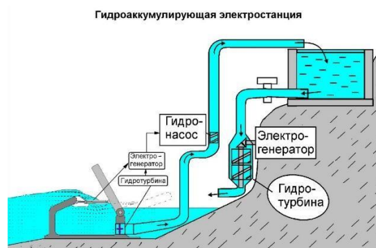
Рисунок 7.6 – Устройство гидроаккумулирующей электростанции
