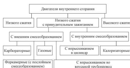
Рисунок 12.1 - Общая схема классификации двигателей
