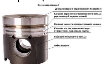
Рисунок 12.4 – Устройство поршня ДВС
