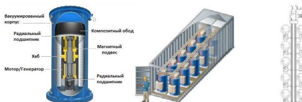
Рисунок 7.11 - Блок-модуль КНЭ суммарной мощностью до 2,5 МВт. Энергоёмкость – 250 кВт/ час. Количество циклов «заряд-разряд» - до 50000. Саморазряд на трение – 2%.
