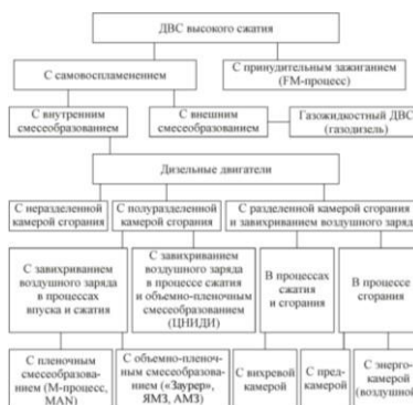
Рисунок 12.2 - Схема классификации двигателей высокого сжатия
