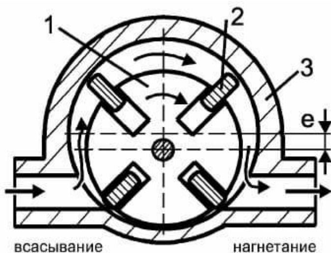
Рисунок 11. Пластинчатый насос.
