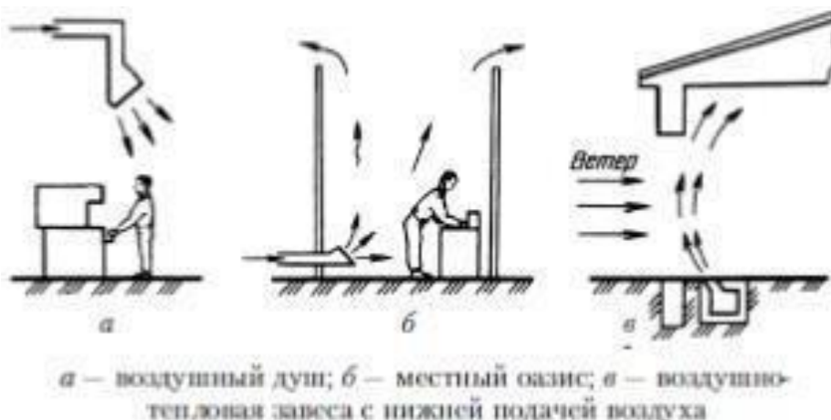
Рисунок 5.5 – Местные приточные вентиляционные устройства
