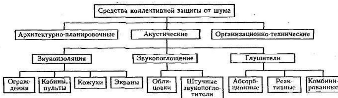
Рис.7.3 - Средства коллективной защиты от шума на пути его распространения
