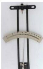
3. Психрометр. (от греческого «психрия» - холод). Состоит из двух одинаковых термометров. Кладовая одного из них обернута марлей, смоченной в емкости с водой. Вода увлажняет марлю в резервуаре термометра и охлаждается, когда она испаряется. Влажность воздуха определяется с помощью психрометрической таблицы из разницы температур между сухим и влажным термометрами.
