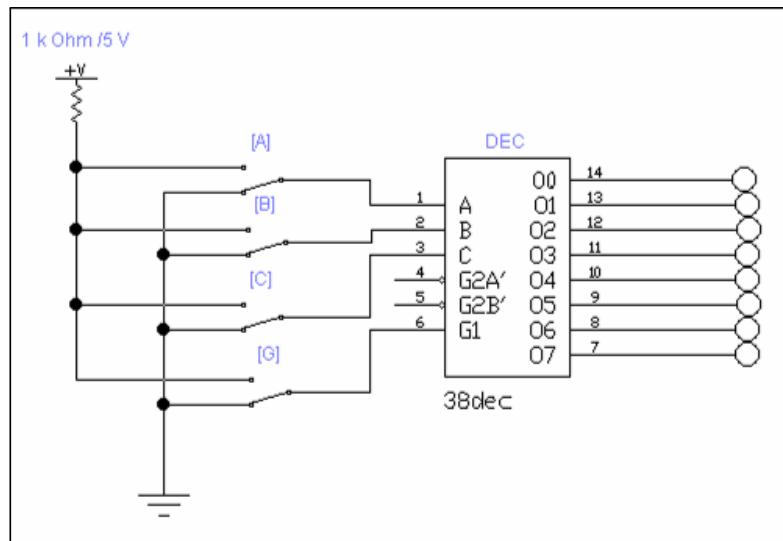
Рисунок 9.3.- Схема включение дешифратора В ней используются следующие элементы: дешифратор (DEC) Generic 3-to-8 Dec; 8 пробников логического уровня;источник сигнала «логическая единица»; заземление;6 соединяющих узлов; 4 ключа, управляемые клавишей (кнопка Switch на панели Basic).
