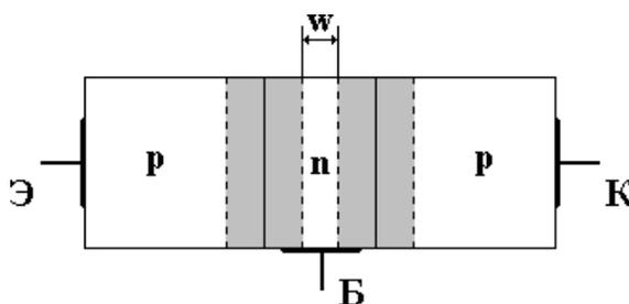
Рисунок 7.1 – Структурная схема плоскостного биполярного транзистора
