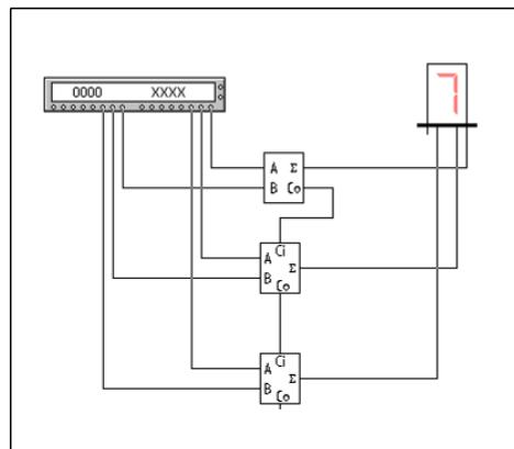
Рис. 11.2. Схема трёхразрядного сумматора Схема состоит из:
