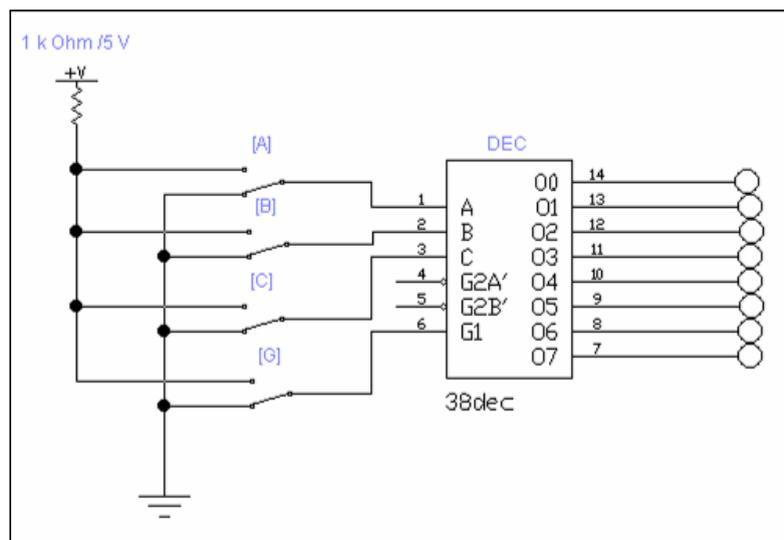
Рисунок 9.3.- Схема включения дешифратора В ней используются следующие элементы: дешифратор (DEC) Generic 3-to-8 Dec; 8 пробников логического уровня; источник сигнала «логическая единица»; заземление; 6 соединяющих узлов; 4 ключа, управляемые клавишей (кнопка Switch на панели Basic).
