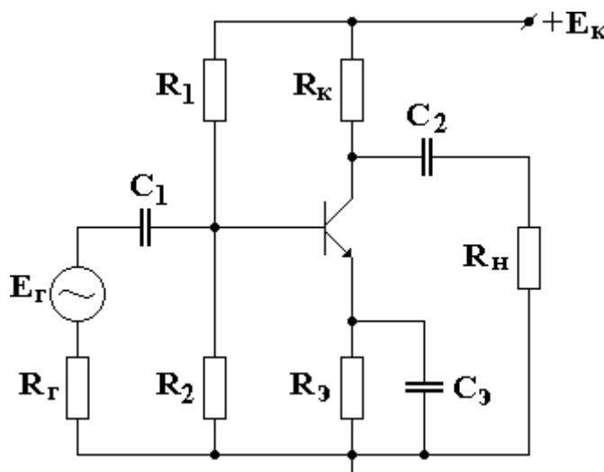
Рисунок 7.3 – Схема включения ОЭ
