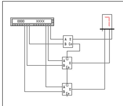
Рис. 11.2. Схема трёхразрядного сумматора
