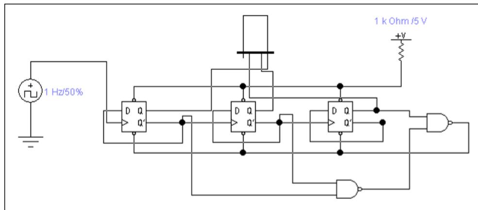
Рис. 11.10. Схема счётчика с коэффициентом деления 5
