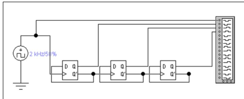
Рис. 11.9. Схема счетчика для анализа диаграмм
