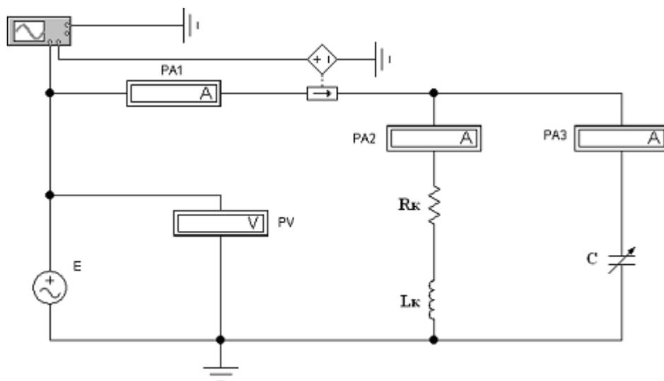
Рисунок 4.1 – Электрическая схема разветвленной электрической цепи синусоидального тока
