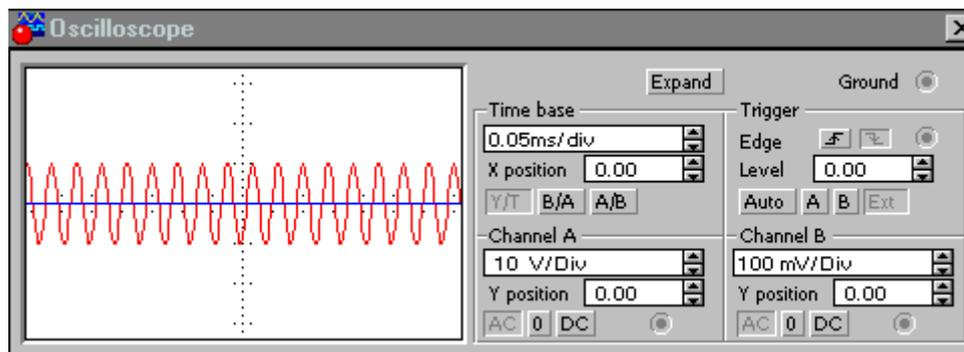
Осциллограф имеет два канала (CHANNEL) А и В с отдельной регулировкой чувствительности в диапазоне от 10 мкВ/дел (mV/Div) до 5 кВ/дел (kV/Div) и регулировкой смещения по вертикали (Y POS). Выбор режима по входу осуществляется нажатием кнопок DC, AC
