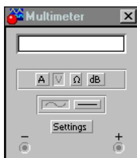
На лицевой панели мультиметра расположен дисплей для отображения результатов измерения, клеммы для подключения к схеме и кнопки управления:
