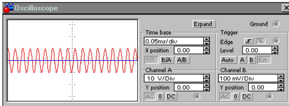
Осциллограф имеет два канала (CHANNEL) А и В с раздельной регулировкой чувствительности в диапазоне от 10 мкВ/дел (mV/Div) до 5 кВ/дел (kV/Div) и регулировкой смещения по вертикали (Y POS). Выбор режима по входу осуществляется нажатием кнопок DC , AC
