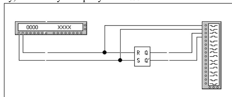
Рис. 11.7. Схема включения RS-триггера
