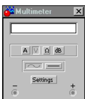
На лицевой панели мультиметра расположены дисплей для отображения результатов измерения, клеммы для подключения к схеме и кнопки управления:
