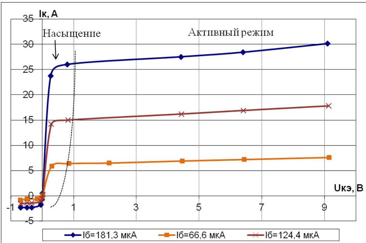
Рисунок 7.13 – Выходные характеристики транзистора с ОЭ
