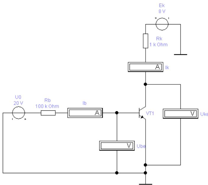
Рисунок 7.13 – Динамический режим работы транзистора, включенного по схеме ОЭ
