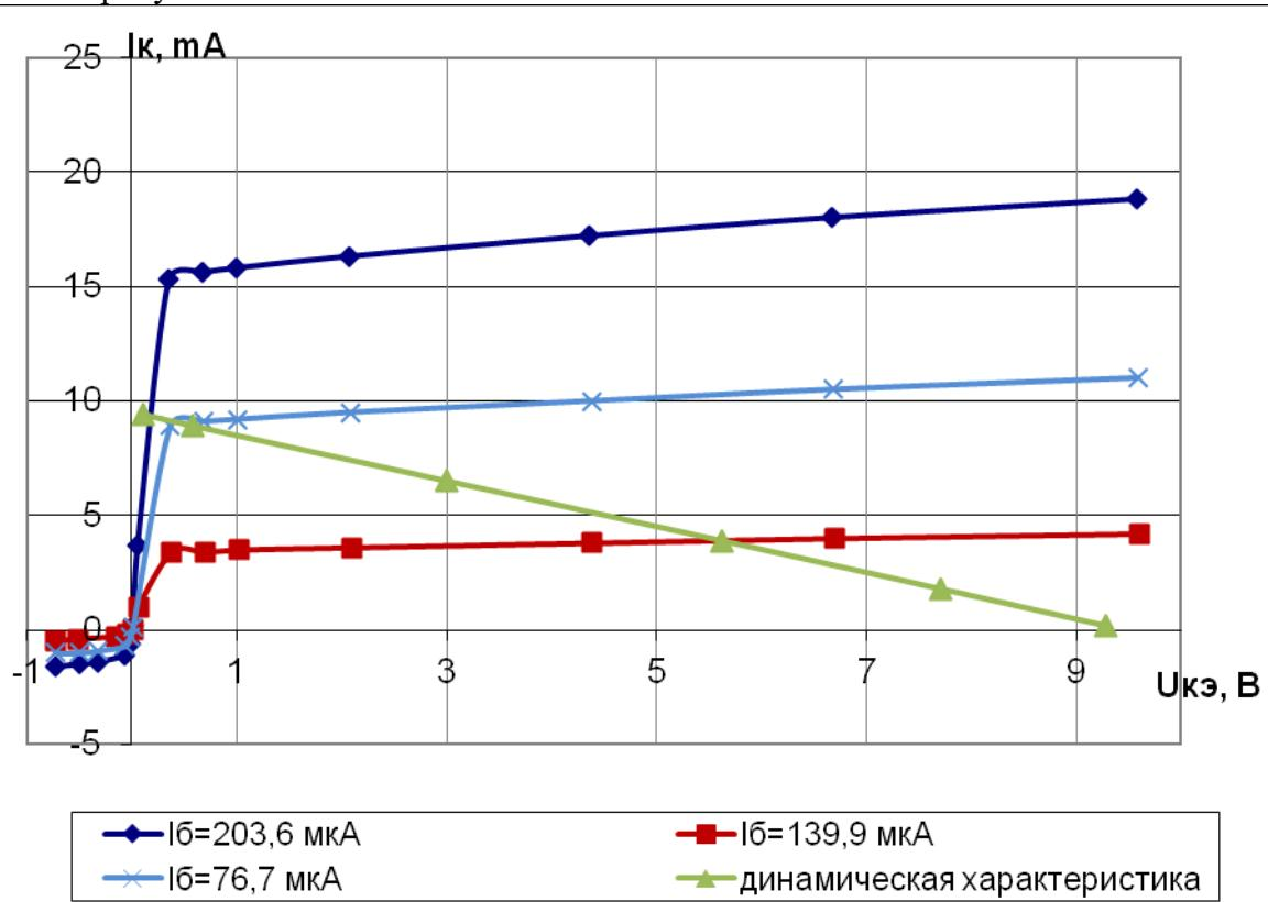
Рисунок 7.14 – Выходная ВАХ транзистора с ОЭ
